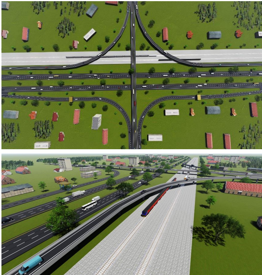
รูปที่ 3-5 แนวคิดการออกแบบจุดตัดและทางเข้า-ออก ช่วงทั่วไป
